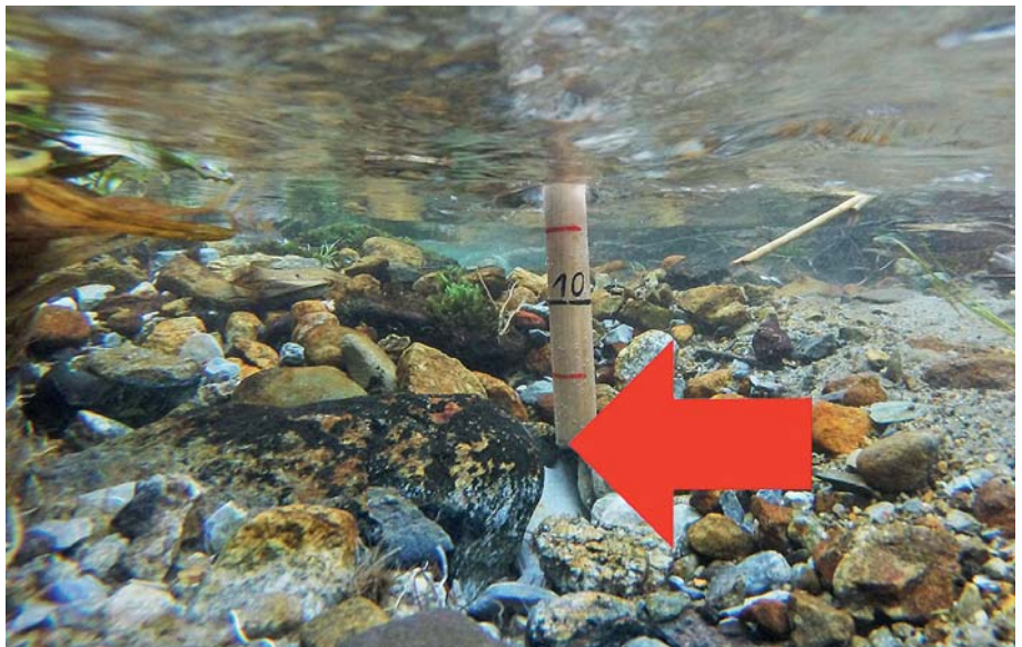
Bild 10. Eine Laichgrubentiefe von ca. 18 cm konnte bei der Kartierung nach Funk et al. (2015) nachgewiesen werden (Bild: Andreas Funk).
